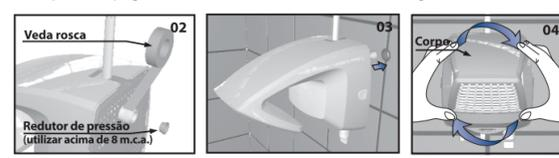
**IMPORTANTE: Faça correr água pelo produto antes de fazer a conexão à rede elétrica, para encher de água a câmara de aquecimento e evitar a queima da resistência.**
