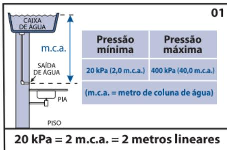
• Para coluna de água entre 80 e 400 kPa, (8 e 40 m.c.a.) ou saída de água proveniente da rua (distribuidora), é necessário encaixar o Redutor de pressão que acompanha o produto no furo do niple de entrada de água (Fig.:02).
