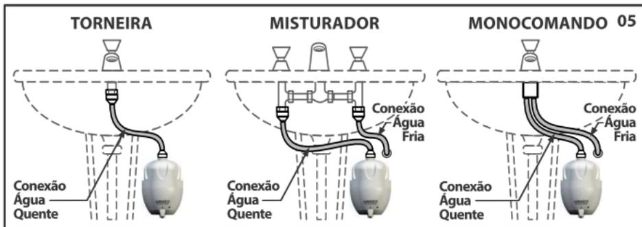
**IMPORTANTE: Faça correr água pelo produto antes de fazer a conexão à rede elétrica, para encher de água a câmara de aquecimento e evitar a queima da resistência.**
