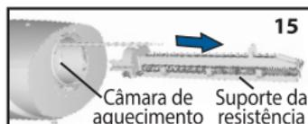
●Empurre o suporte da resistência encaixando-o no interior da câmara de aquecimento (Fig.:16).
