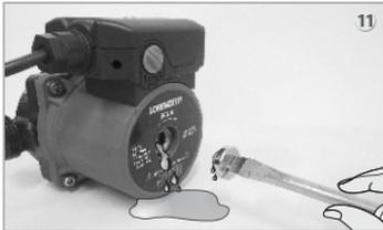
Retire el tornillo de drenó con un destornillador, y espere hasta que salga todo el aire del sistema, utilice una vasija para recoger el agua. A continuación, vuelva a colocar el tornillo.
