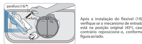
Após a instalação do flexível (19), verifique se o mecanismo de entrada está na posição original (45°), caso contrário reposicione-o, conforme figura ao lado.
