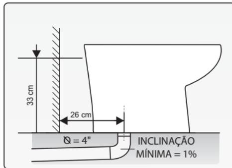
3-Fure o piso com broca de  $\varnothing 10$  mm nos pontos marcados.
