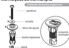
1) -Monte cada fixador com o conjunto de bucha expansora (1) no fixador (2), e a baseta anti-
