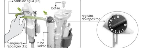
Instale a mangueira de reposição (15), conforme figura acima. Encaixe uma ponta na saída de água (16) do mecanismo de entrada e a outra extremidade deve ser encaixada no tubo ladrão (17). Abra o registro para encher a caixa.
