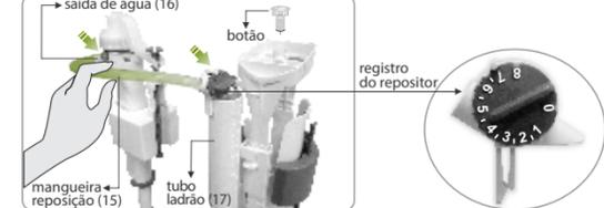
Instale a mangueira de reposição (15), conforme figura acima. Encaixe uma ponta na saída de água (16) do mecanismo de entrada e a outra extremidade deve ser encaixada no tubo ladrão (17). Abra o registro para encher a caixa.
