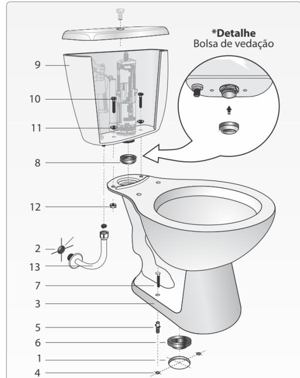
BACIA COM CAIXA ACOPLADA - DUPLO ACIONAMENTO
