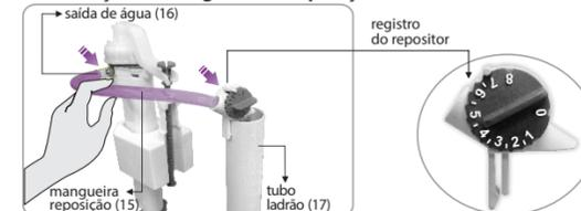
Instale a mangueira de reposição (15), conforme figura acima. Encaixe uma ponta na saída de água (16) do mecanismo de entrada e a outra extremidade deve ser encaixada no tubo ladrão (17).
