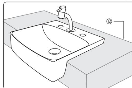
Observação: Se precisar remover a cuba após a colagem, use uma faca aquecida para inserir entre o tampo e a cuba, movimente horizontalmente até descolar a cuba do tampo.
