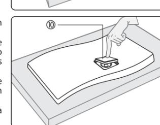
Observação: Se precisar remover a cuba após a colagem, use uma faca aquecida e movimente horizontalmente até descolar a cuba do tampo.
