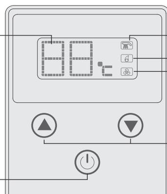
Indica fluxo normal de água pelo aquecedor quando em funcionamento.
