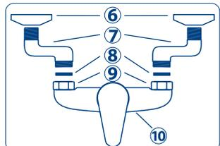
OPÇÃO 2 - Ponto de instalação com distância entre saídas de água quente e fria de 200 +/- 7mm.
