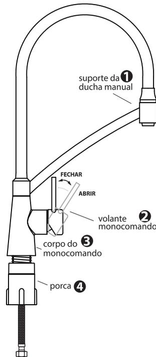
ATENÇÃO - Não use palha de aço ou qualquer produto químico na limpeza dos metais. Na instalação das peças, evite o uso de chaves de aperto nas partes cromadas, e jamais utilize produtos tóxicos nas roscas de entrada.
